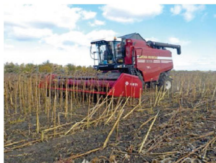
Жатка НАШ-7,4-04 в агрегате с КЗС-1218 на уборке подсолнечника
